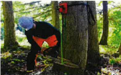
■受け口ガイド板 受け口の水平度、方向、深さが確認できます。
